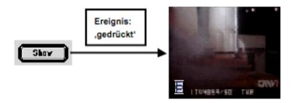
Die Video-Clip-Komponente muss sich bei der Schaltfläche registriert haben, dass sie über das Eintreten von Ereignissen informiert wird. Beim Aktivieren der Schaltfläche wird die Video-Clip-Komponente durch die Nachricht, dass das Ereignises "gedrückt" eingetreten ist, von der Schaltflächenkomponente informiert. Die Video-Clip-Komponente kann nun darauf reagieren, indem der mit der Komponente assoziierte Video-Clip abgespielt wird.
